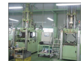
ゴム射出成型機 Rubber injection molding machine
