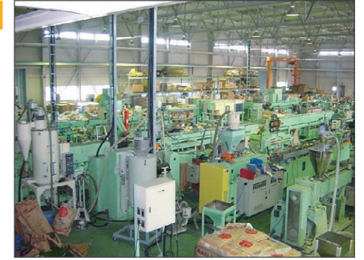
樹脂押出工場 押出ラインは、押出機、冷却装置、切断機、巻取機等の各装置で構成されています。
