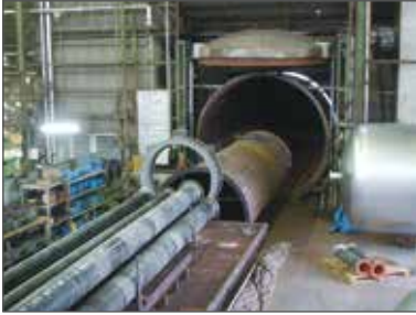
加硫缶 / Vulcanizing Autoclave (4mφ)
