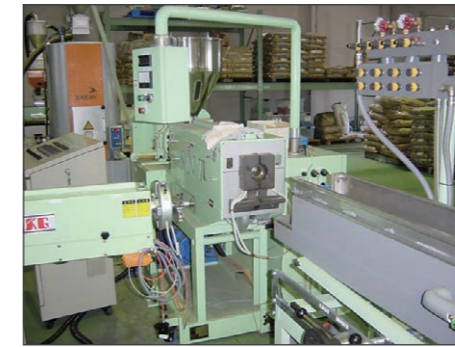
小型異形ライン Production line of small-sized profile extrusion
