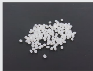
ペレット状の熱可塑性エラストマー Pellets of Thermoplastic Elastomer
