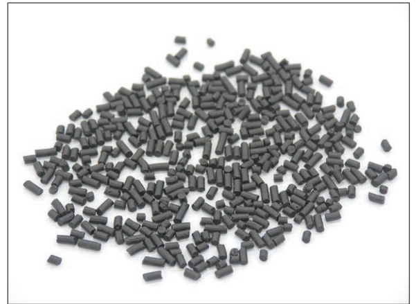
エラスダムシートに埋め込まれているセラミックチップ Ceramic tiles molded into ELASDUM SHEET
