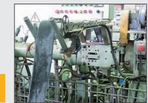
ゴム素材の投入 Feeding rubber material
