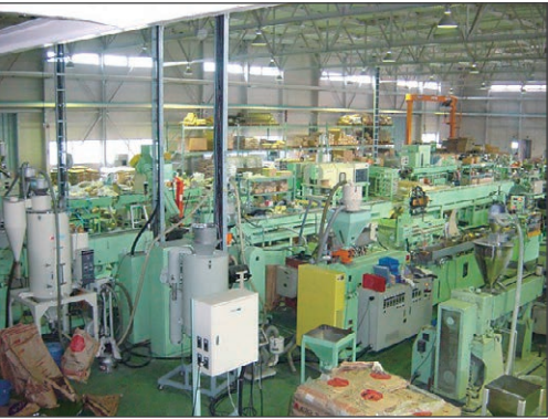
樹脂押出工場 押出ラインは、押出機、冷却装置、切断機、巻取機等の各装置で構成されています。
