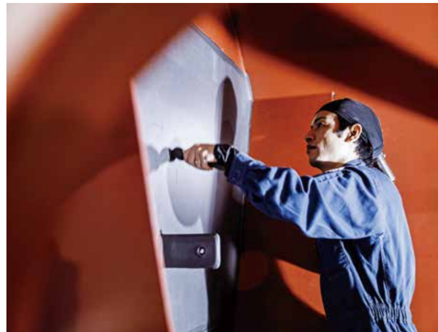
ゴム貼り工程 Rubber Lining Application
